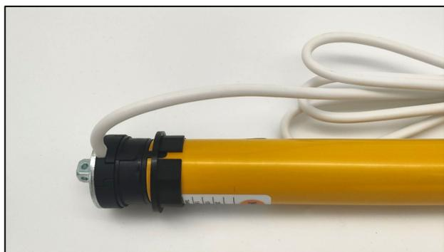
Es muy importante que la corona esté bien colocada, puesto que es la encargada de contar las vueltas que realiza el motor y permite el buen funcionamiento de los finales de carrera.
